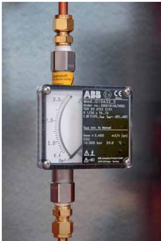
Bild: Durchflussmesser für Zumischgas
