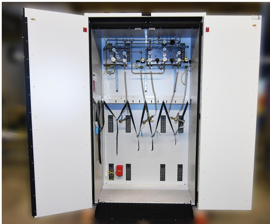
**Bild 2** Zulässiger  $\text{SO}_2$  Schrank: Ein, den Vorschriften entsprechender und somit geeigneter  $\text{SO}_2$ -Schrank, kann zum Beispiel wie auf diesem Bild aussehen. Deutlich zu erkennen ist der feuerfeste Schrank mit Lüftungssystem, der unten angebrachte Gaswarnsensor und die Druckregelstation mit Spüleinrichtung. Die unten erkennbare Rampe dient dem einfachen und sicheren Be- und Entladen.
