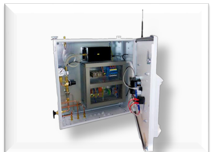
Automatische Gasmischerumschaltung mit LT GasAnalysator mit E-Mail-Versand
