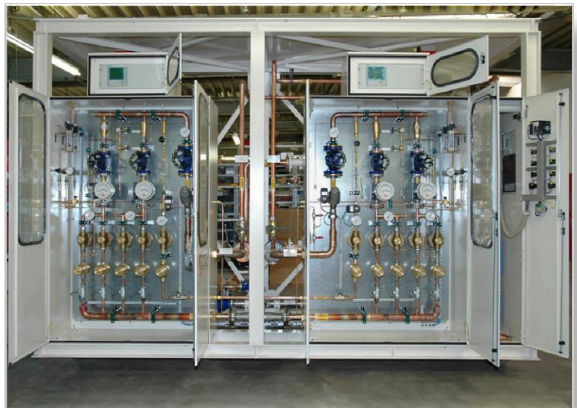
Redundante Gasmischer mit redundanter Gas-Analyse
