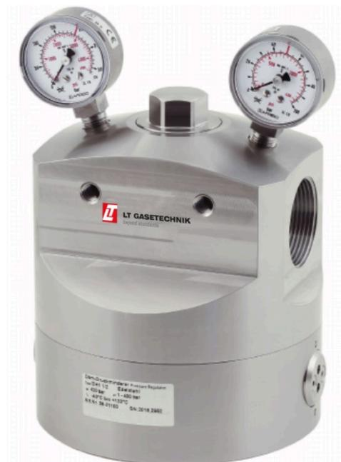
Der Domdruckregler LTD-1 ½ zeichnet sich durch hohe Regelgüte und großen Durchsatz aus. Zwischen Domkammer-Druck und Ausgangsdruck wird ein Gleichgewichtsdruck erzeugt. Durch den druckentlasteten Ventilkegel werden Schwankungen im Vordruck weitestgehend ausgeglichen.
