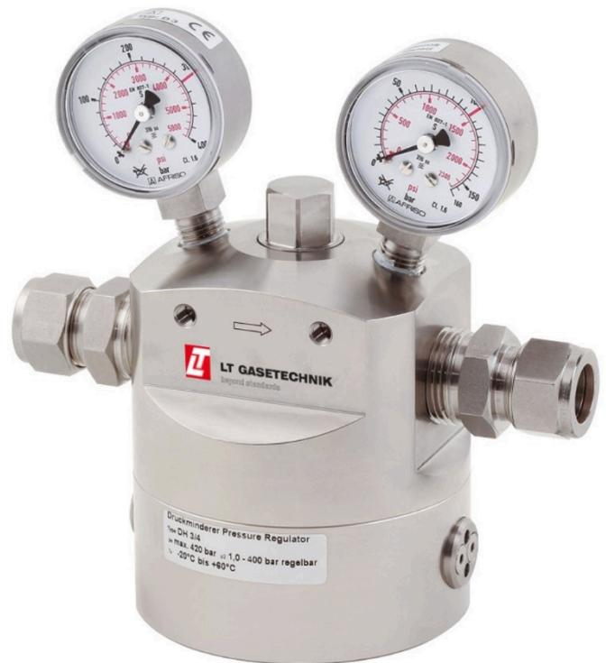
Der Domdruckregler LTD-3/4 – HD mit integriertem Pilotdruckregler zeichnet sich durch hohe Regelgüte und großen Durchsatz aus. Zwischen Domkammer-Druck und Ausgangsdruck wird ein Gleichgewichtsdruck erzeugt. Durch den druckentlasteten Ventilkegel werden Schwankungen im Vordruck weitestgehend ausgeglichen.
