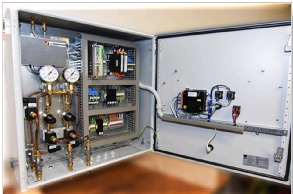
Redundanter LT GasAnalysator im Wandgehäuse mit automatischer Gasmischerumschaltung und automatischer Nullpunkt- und Endpunkt-Kalibrierung
