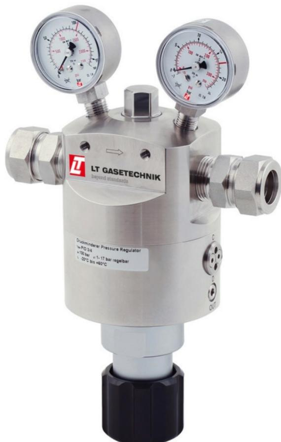
Der Domdruckregler LTD-3/4 – HD mit integriertem Pilotdruckregler zeichnet sich durch hohe Regelgüte und großen Durchsatz aus. Zwischen Domkammer-Druck und Ausgangsdruck wird ein Gleichgewichtsdruck erzeugt. Durch den druckentlasteten Ventilkegel werden Schwankungen im Vordruck weitestgehend ausgeglichen.
